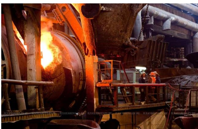
Идет зарядка конвертера штейном. Конвертер начинает поворачиваться для загрузки
