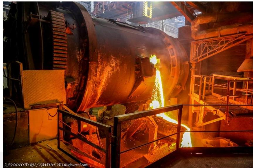
Процесс конвертирования ведут при температуре 1200-1250°C
