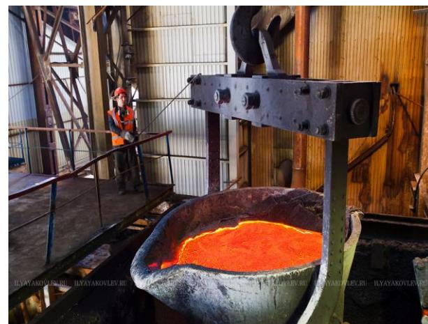
Рабочий контролирует транспортировку ковша штейна в конвертерное отделение
