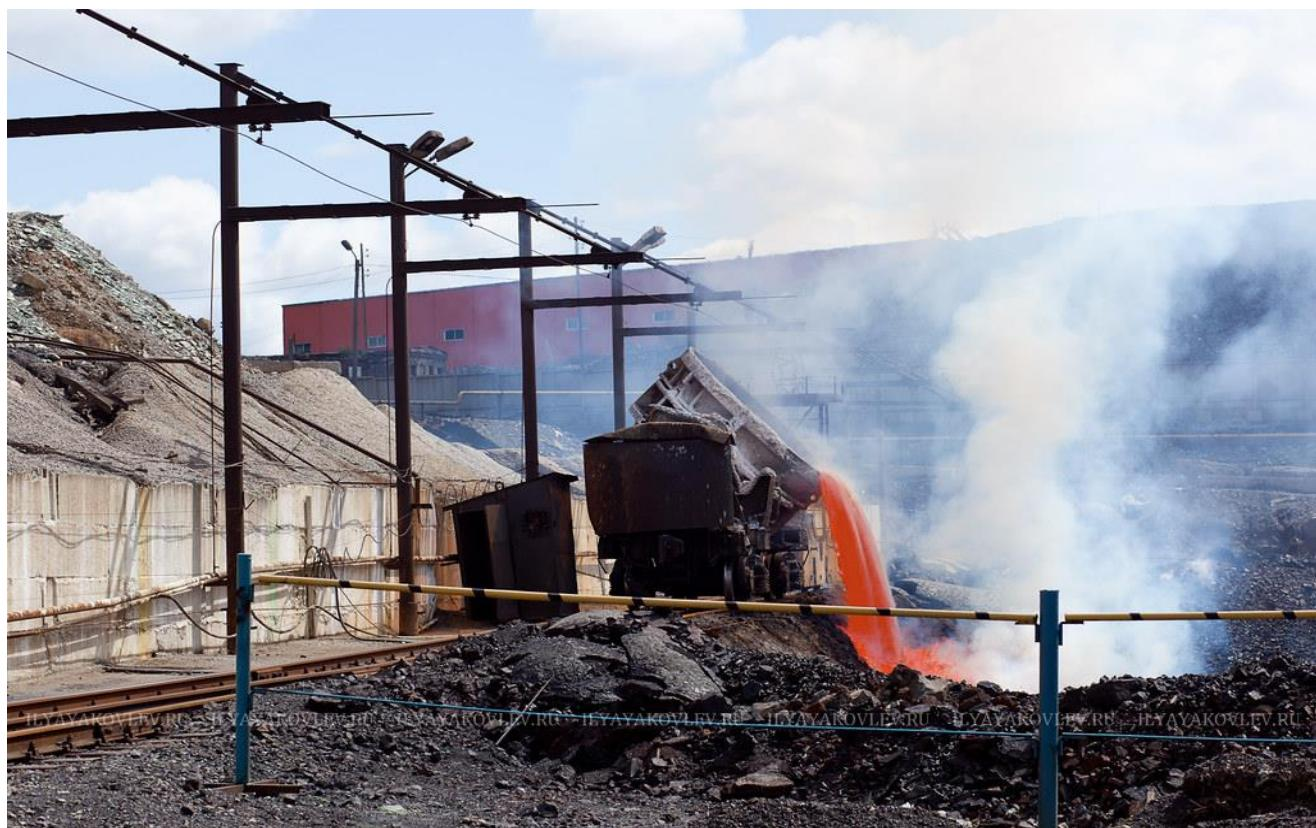
Шлак сливается в несколько ям, охлаждается водой, которая поступает со стоек слева. Экскаватор разбивает застывший впоследствии шлак и отгружает его
