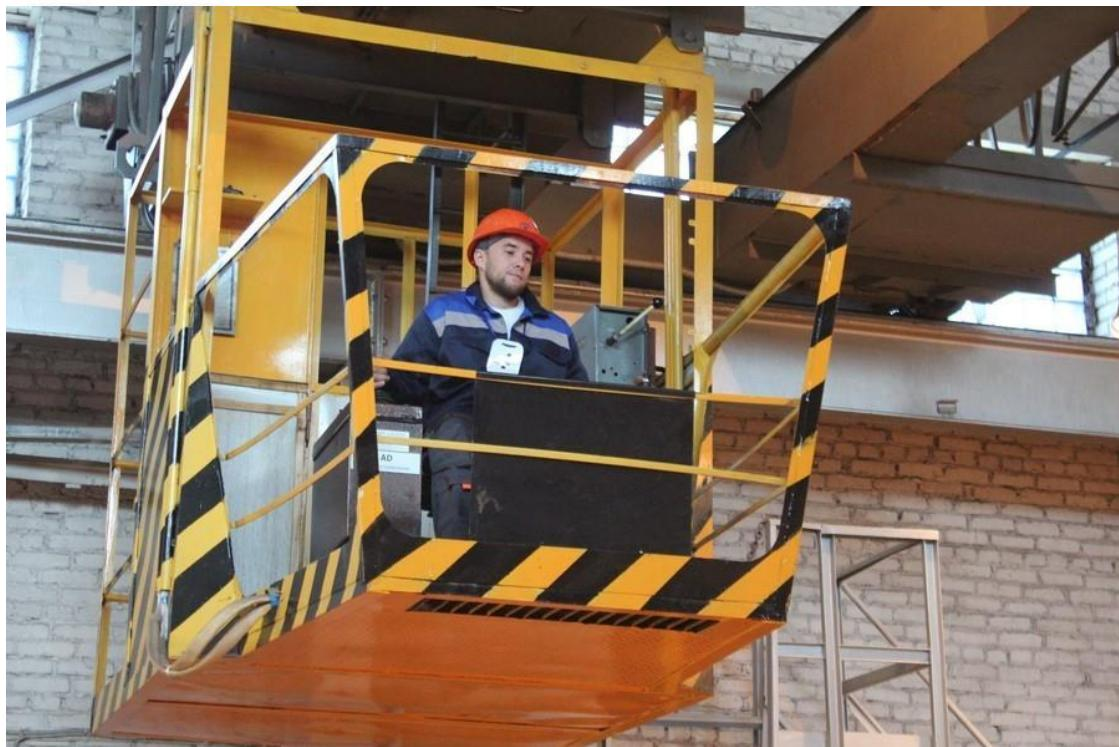
Крановщик управляет подъемными механизмами, перемещая различные грузы. Например, многотонные трубы или пакеты труб. Работа тонкая, ювелирная, требующая выдержки, острого глазомера и точности. Интересный факт: чаще управлять мостовым краном идут женщины. Некоторые сравнивают свою профессию с ездой на автомобиле: сначала вроде сложно, непонятно, страшно, потом все приходит с опытом, получаешь удовольствие от самого процесса.
