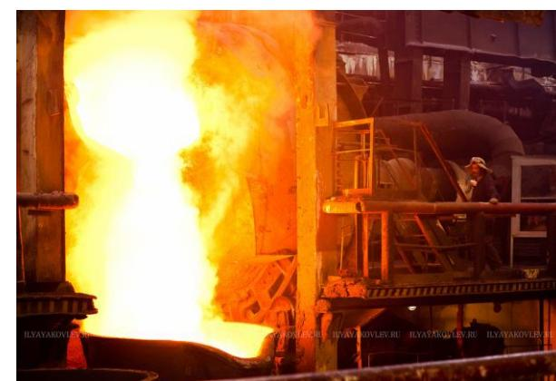
Слив конвертерного шлака, загрузка конвертера холодными присадками (контейнер сверху)
